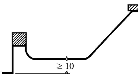
2. Der Krippenboden muss mindestens 10 cm höher sein als das Niveau des Lagers (bzw. der Gummimatte; Abb. 2).
